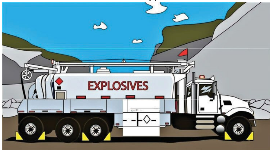
Figure 4 – Les véhicules transportant des explosifs en surface doivent être munis d'indications claires qu'ils transportent des explosifs et d'un drapeau rouge.
